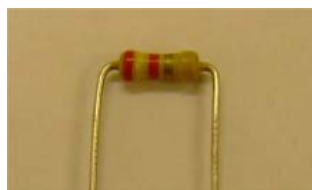
Bild 4: Abwinkeln der Anschlussdrähte der Widerstände
